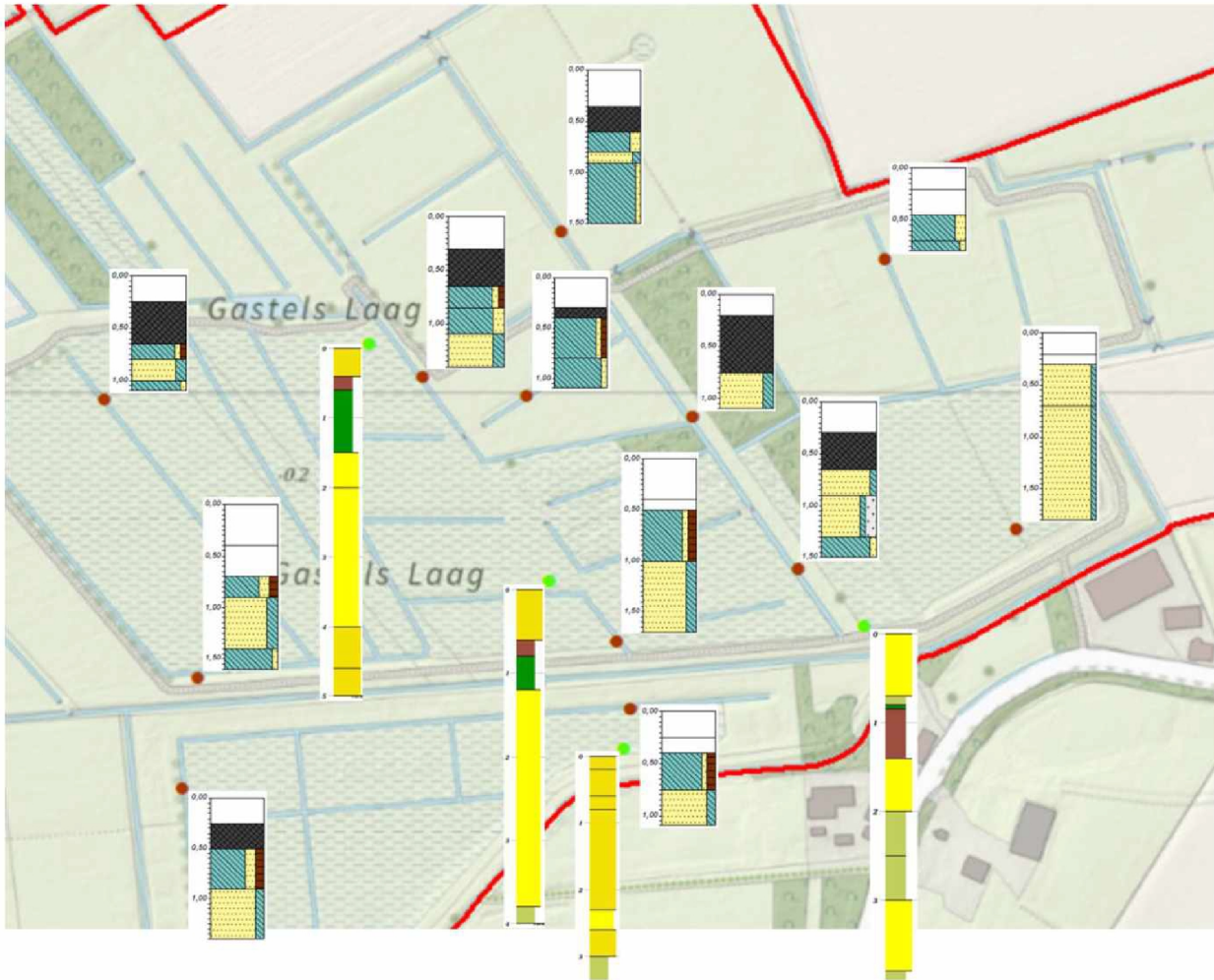
Figuur 3-8 Bodemopbouw natuurterrein Gastels Laag. In het natuurterrein is in 12 sloten de bodemopbouw van de slootbodems bepaald. Om het beeld compleet te maken zijn in deze figuur ook de bodemprofielen van het meetnet van Brabant Water opgenomen. Groene markers: boorbeschrijvingen meetnet Brabant Water (Dinoloket 2021). Bruine markers: boorbeschrijvingen van handboringen in slootbodems in het natuurterrein. De boringen starten op de slootbodem. Het bovenste deel van de boring bestaat in de regel uit losse samendrukbare plantenresten (hier wit weergegeven) of slib.
