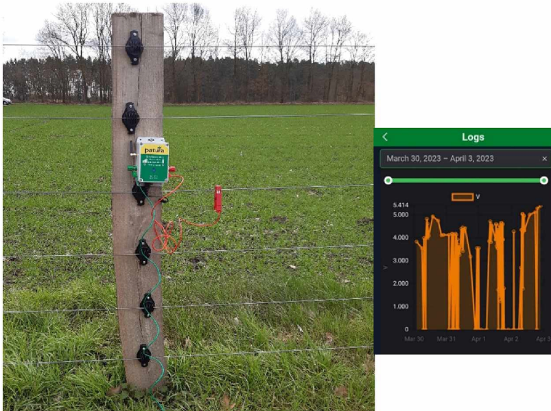
Abb. 4: Messung der Spannung am Weidezaun mittels Zaunmonitor sowie beispielhaft die aufgezeichneten Daten eines Weidestandortes.
