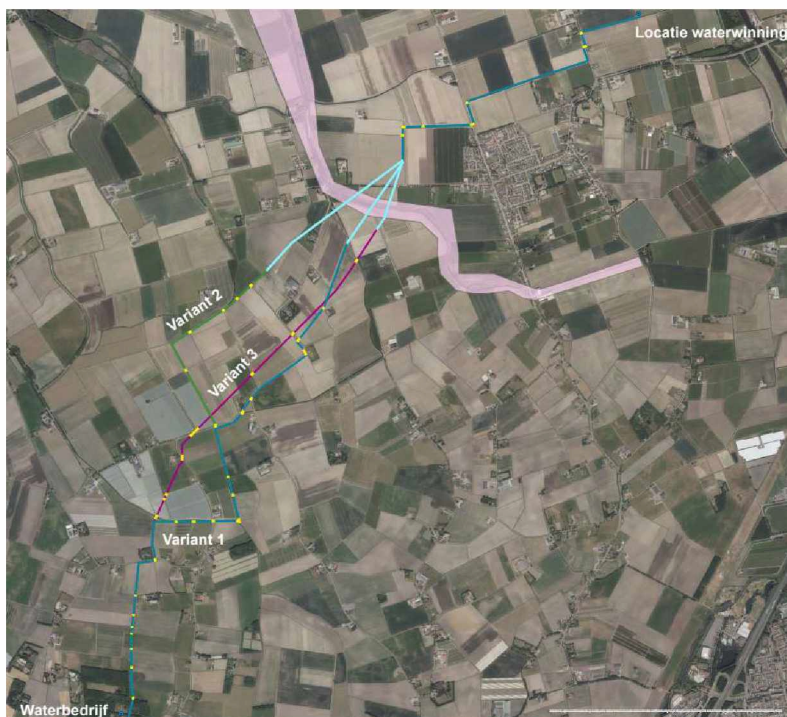
Figuur 1 Ligging van de drie tracé varianten. In licht blauw de gestuurde boring onder de Tuimerlaars Kreek (in lila)
