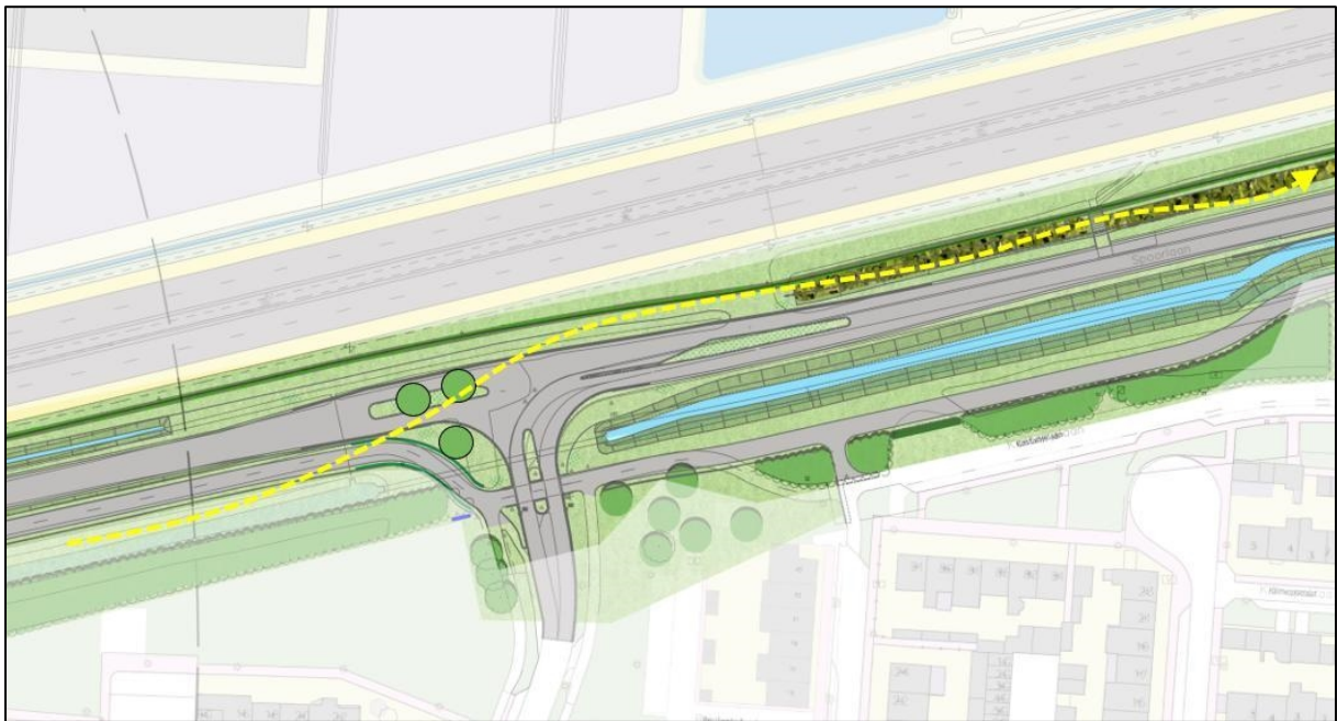
Afbeelding 6 Extra boomaanplant ter plaatse van kruising Kastanjelaan-West/ Spoorlaan t.b.v. veilige oversteek richting zijde geluidscherm.
