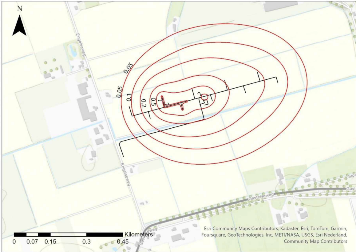
Figuur 9: Verlagingen (in meters) in de omgeving bij GHG na aanleg ondiepe kelder (eind maand 8)
