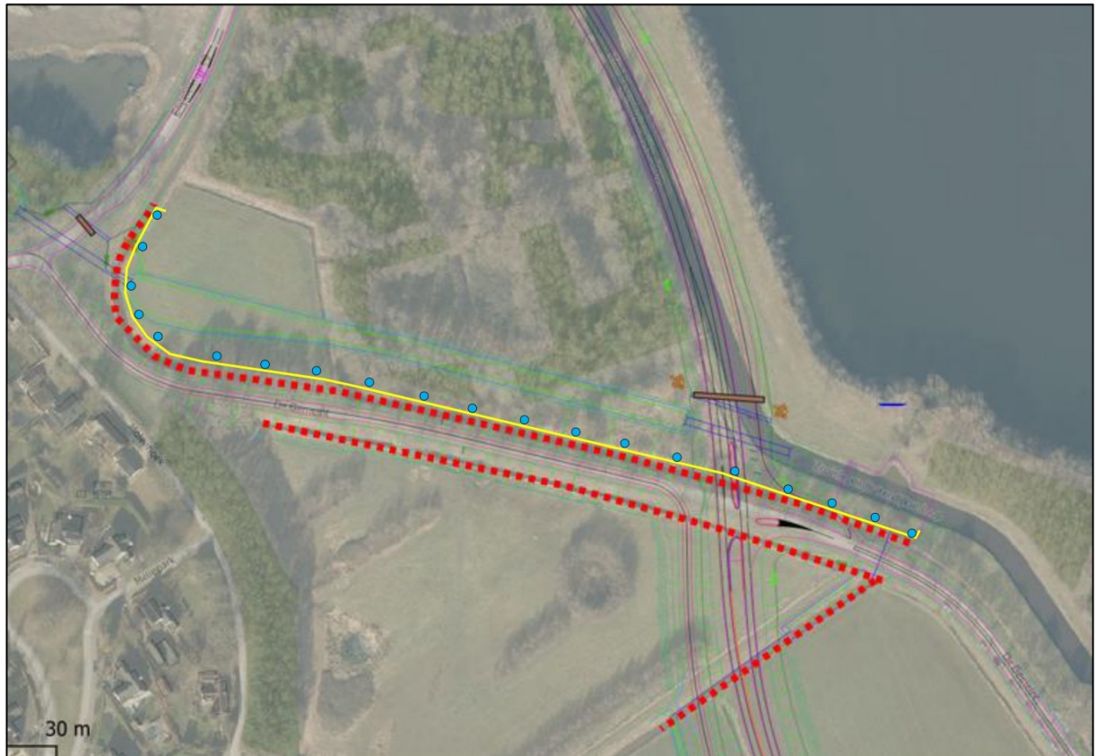
Afbeelding 3.18 HDPE amfibieënscherm (gele lijn) en vangemmers (blauwe stippen) ter plaatse van de te dempen watergangen (ronde stippelij) langs de Gemeint.
