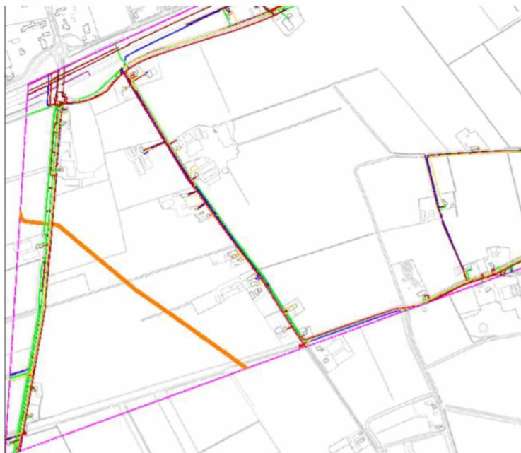
Figuur 16.3 Impressie ligging kabels en leidingen binnen centrale gedeelte plangebied, voornamelijk langs wegen (oranje = hogedruk aardgastransportleiding)
